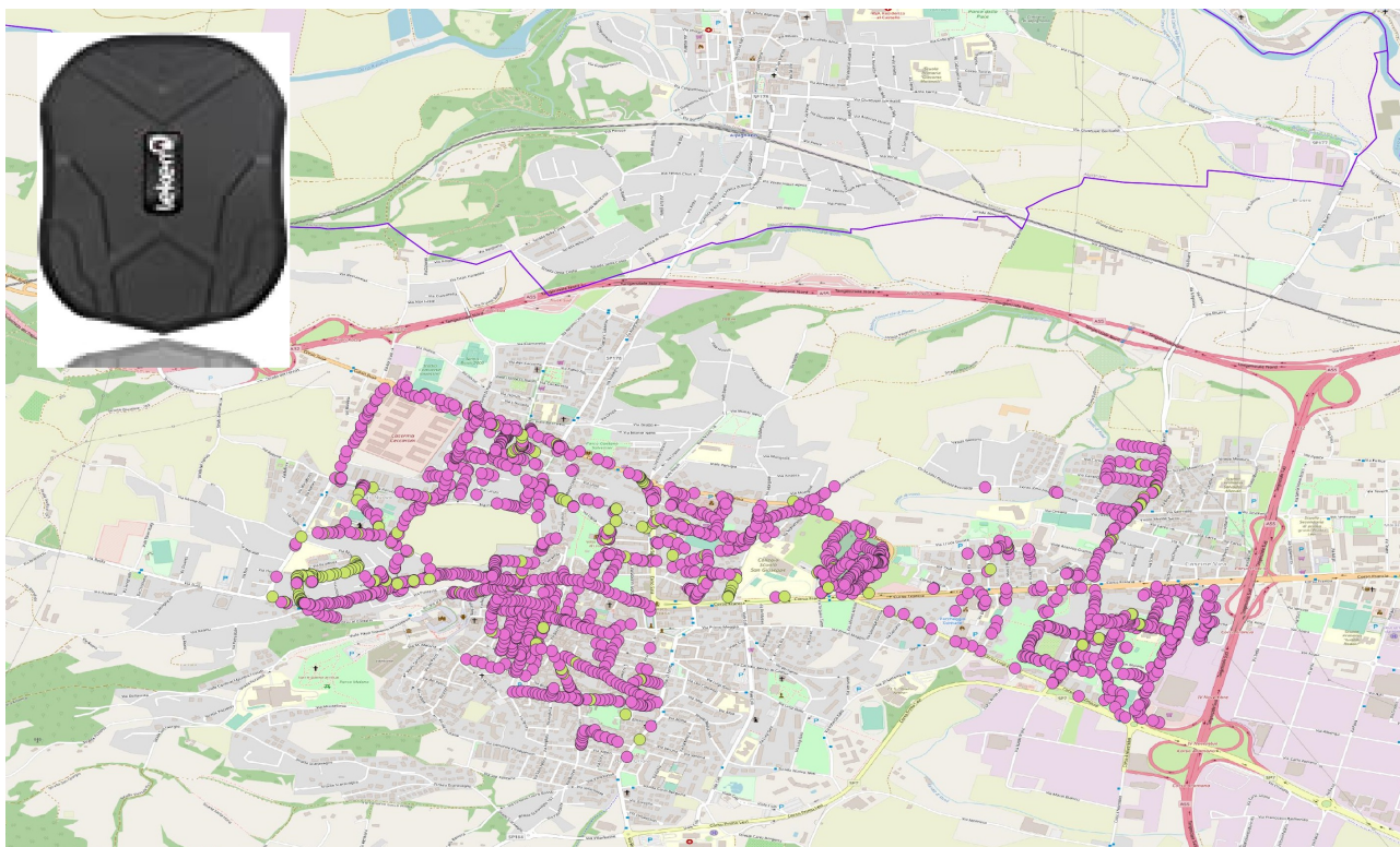
Fig. 20 – Esempio di mappa cartografica prodotta dalla strumentazione GPS in seguito al trattamento delle caditoie stradali.
